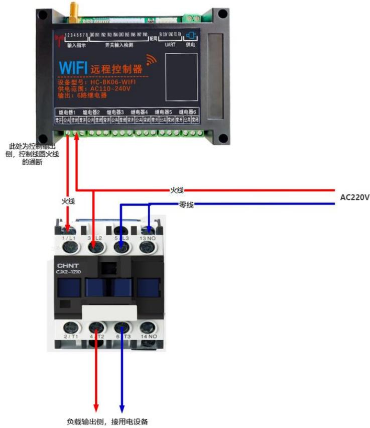
下图为用第一路通道控制 220V 线圈的交流接触器并带 380V 负载:
