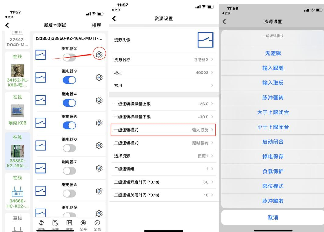
①**通电闭合**：选择此模式后设备断电再通电之后继电器将立即吸合并保持，直至手动关闭；
