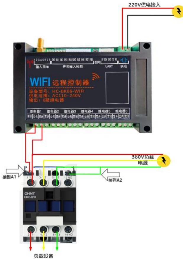
下图为用第一二路通道控制两线制电机正反转，第一路打开是正转，第二路打开是反转，同时打开或者关闭电机不转：
