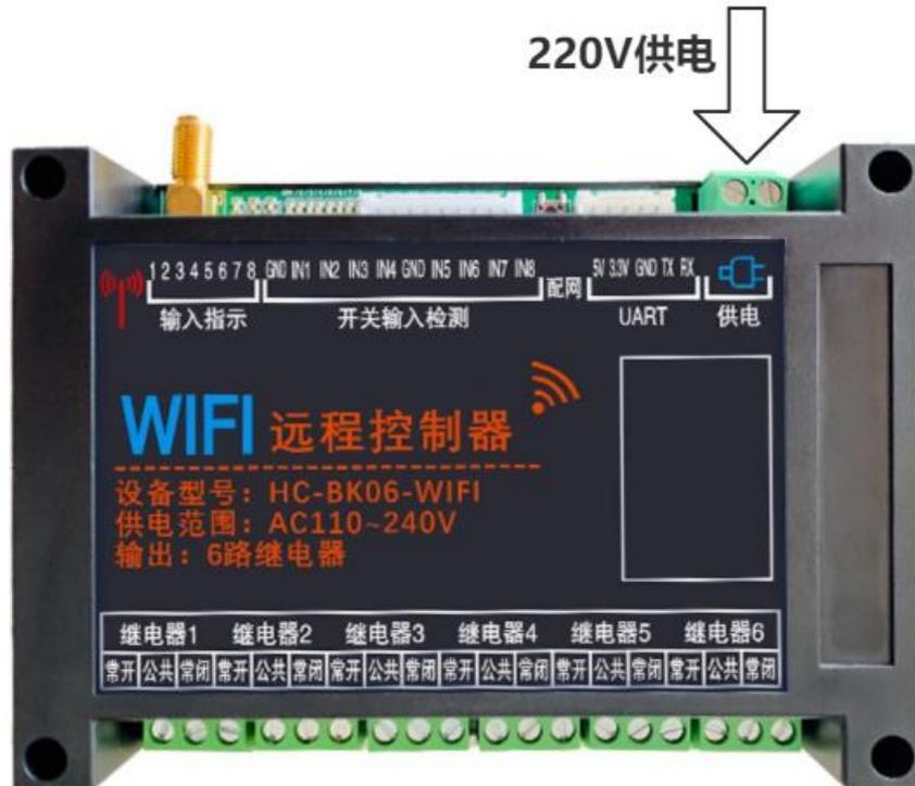
在电源线正常连接后，控制器的 pow 灯常亮，为红色；
