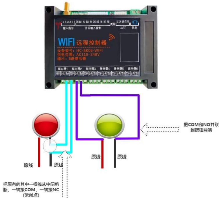
下图为用第一路通道控制 220V 线圈的交流接触器并带 220V 负载：
