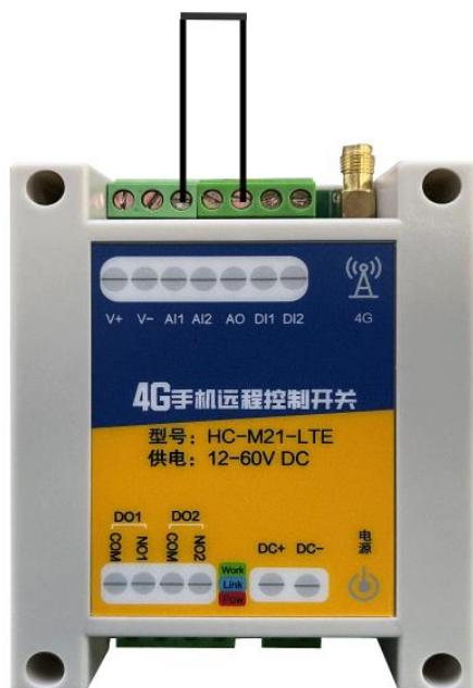
再以控制调节型阀门为例，AO 和 V- 即为模拟量输出的接线端，为有源两线输出的 **4-20ma** 信号，接到阀门的模拟量输入端的信号正和信号负即可。
