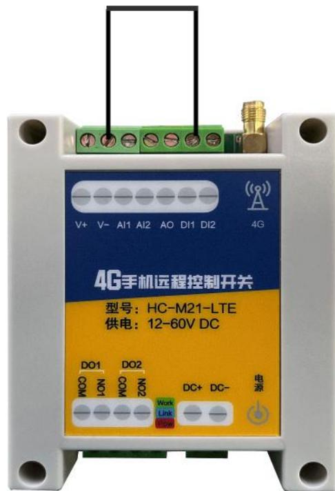
一般常用于监测交流接触器的常开辅助触点信号来作为状态反馈，接线如下所示：
