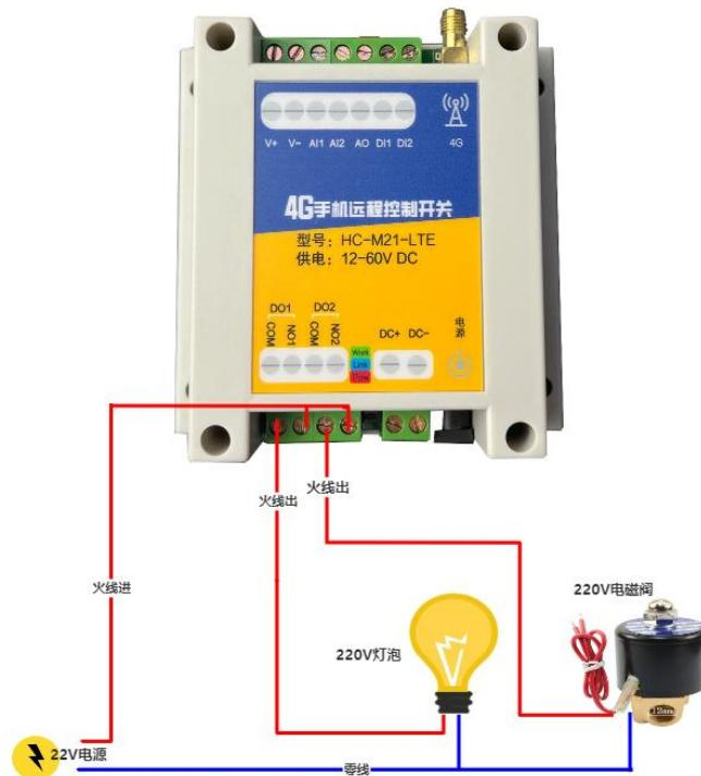
下图为用第一路通道控制 220V 线圈的交流接触器并带 220V 负载：
