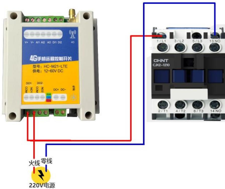
下图为用第一路通道控制 220V 线圈的交流接触器并带 380V 负载：
