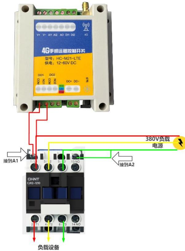
下图为用第一二路通道控制三线制电机正反转，第一路打开是正转，第二路打开是反转，同时打开或者关闭电机不转：
