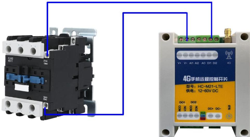
一般常用于监测限位、浮球、红外等开关信号以及可以接自复位式按钮开关，接线如下所示：
