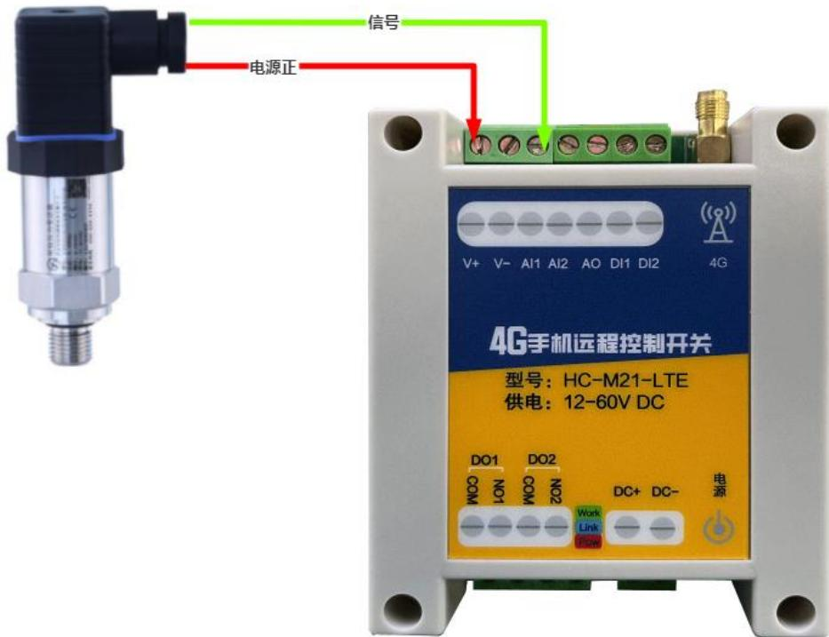
三线制模拟量传感器接线到控制器的第一路模拟量采集，需要：
