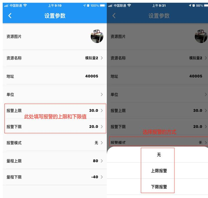
**逻辑联动相关：**进入继电器的参数设置界面，需要填写**逻辑控制上限和下限**（注：不同型号的产品此处名称可能大同小异，比如有的型号叫做一级逻辑上限、下限。），然后选择合适的**逻辑控制模式**（注：不同型号的产品此处名称可能大同小异，比如有的型号叫做一级逻辑。），然后**资源绑定**选择对应的资源（如要受模拟量 1 联动就选择资源 1，要受模拟量 2 联动则此处选择资源 2）。
