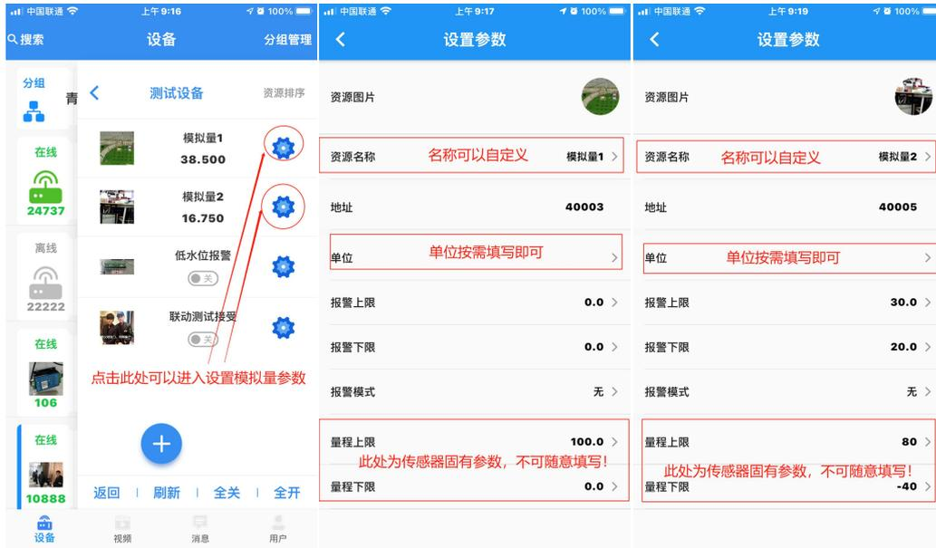
**报警参数的填写：**如图中所示设置报警上限为 30，报警下限为 20，若设置报警模式为上限报警，则会实现这样的功能：当温度高于 30℃的时候报警，一直到低于 20℃的时候解除报警；
