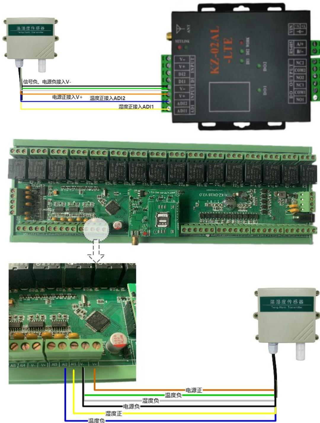
**APP 配置量程参数：**首先点击进入模拟量参数的设置界面，然后可以对资源名称和资源图片进行参数的修改，比如模拟量 1 名称修改为“湿度”，模拟量 2 名称修改为“温度”，单位可以分别填写“%”“℃”，湿度的量程上限为 100，下限为 0，温度的量程上限为 80，下限为-40。那么量程就设置完成了，可以返回查看采集到的传感器其数据即为真实数据了。
